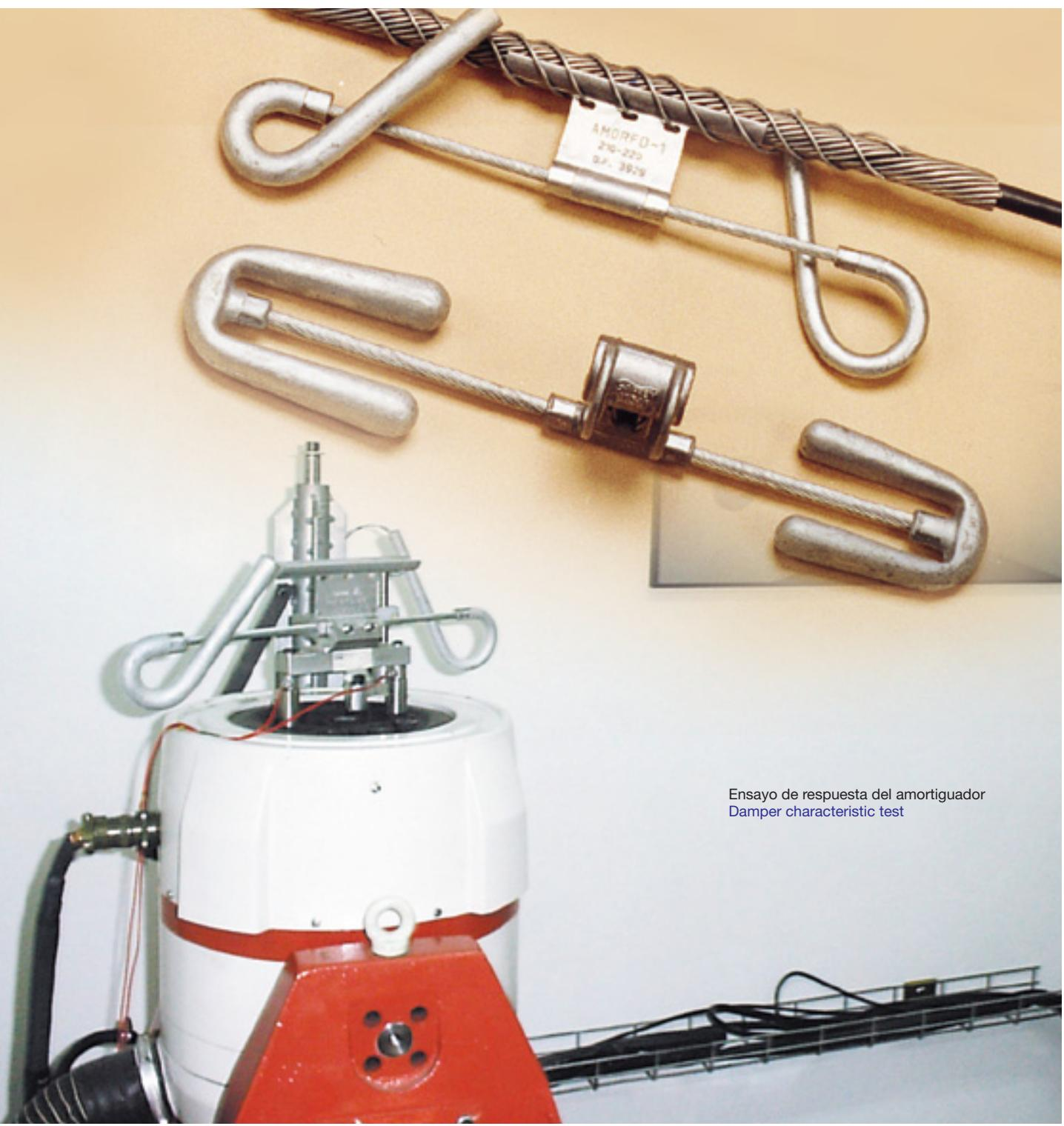
Ensayo de respuesta del amortiguador
